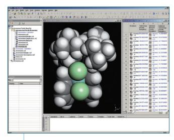
上図の有機金属錯体、ジルコノセンの構造は複雑なエ ネルギープロファイルを有します。Forcite Plus はスタ ディテーブルと連携することによりこの構造における最 低エネルギーを計算します。
