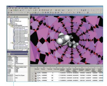
Forcite Plusはさまざまな系の動的振る舞いを研究することが可能です。上図では、有機一無機構造の研究対象の典型である、メタンがゼオライト細孔から拡散する様子が示されています。トラジェクトリファイルをアニメーション化することにより拡散の道筋を視覚化し、エネルギーや格子定数など時間変化を解析できます。
