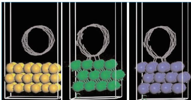
図1 金属表面上の(8, 0)SWNT: (a) Au(100); (b) Pd(111); (c) Pt(111)。Auの表面では、SWNTは弱く物理吸着しています。PdとPtの表面の場合は、金属に隣接している炭素原子にsp<sup>2</sup>からsp<sup>3</sup>への転移が生じ、CNTの横断面がかなり変形します。Pd上の結合はPtよりもわずかに強くなります。
